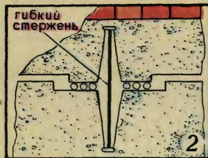
Возможные конструкции для сейсмостойких зданий: 1 — с массивным чугунным шаром между верхней и нижней частями фундамента; 2 — с гибкой связью в виде бетонного стержня; 3 — на эллипсоидах.
